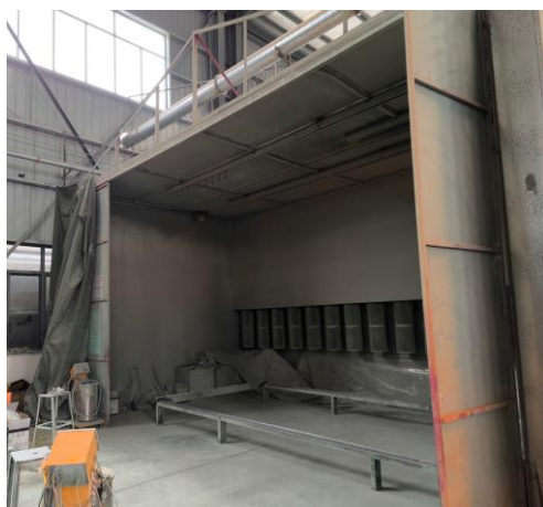
图 2-7 可全封闭式静电喷塑室
