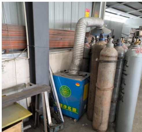
图 2-6 移动式焊烟净化器
